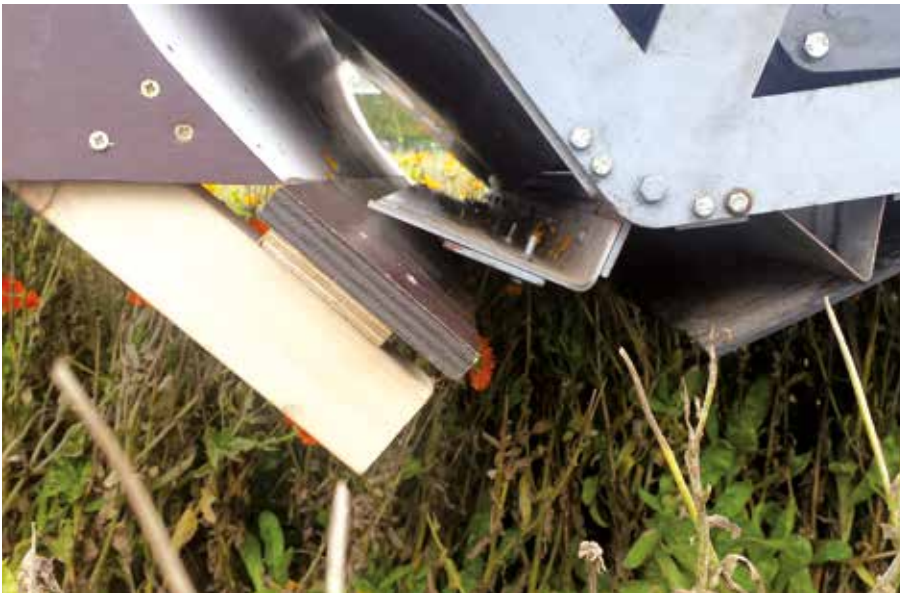
Het verlies aan bloemen werd beperkt door het aanbrengen van een geleidingsplaat vóór de rotor.
