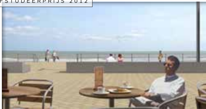
FIGUUR 2 dijkversterking in de vorm van een laag muurtje (60 cm), uitgevoerd als zitbank en geplaatst op enkele meters van de dijkrand [BRON: PLAN-MER GEÏNTEGREERD KUSTVEILIGHEIDSPAN]
