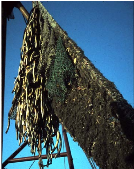
Figuur 4: gebruik van fietsband ter bescherming net (1976)
